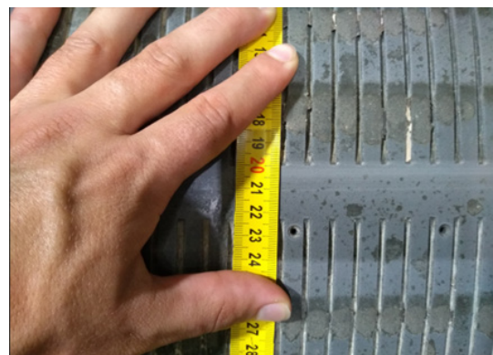
In diesem engen Bereich schneiden die Quermesser auf der Tragwalze
